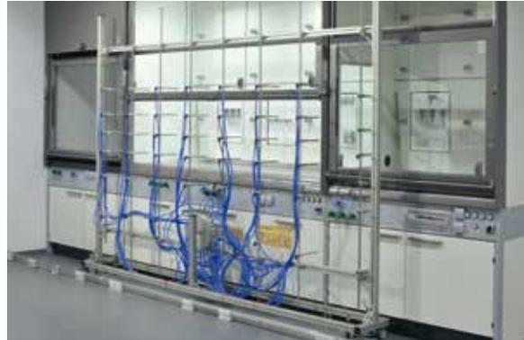
EN 14175 parte 6, prueba normalizada según punto según 5.4; Medición en la pantalla exterior
